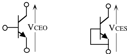
Figura 1.7. Definición de V_{CEO} y V_{CES} .
